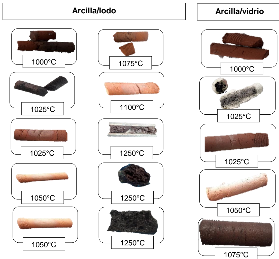
Figura 24. Estructuras obtenidas de la síntesis del cerámico celular sometidas distintas temperaturas.
