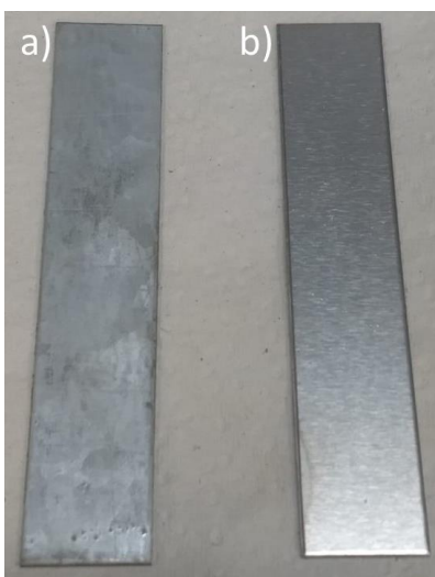
Figura 9. Placas de acero AISI: a) Sin limpieza y b) decapada y activada.
