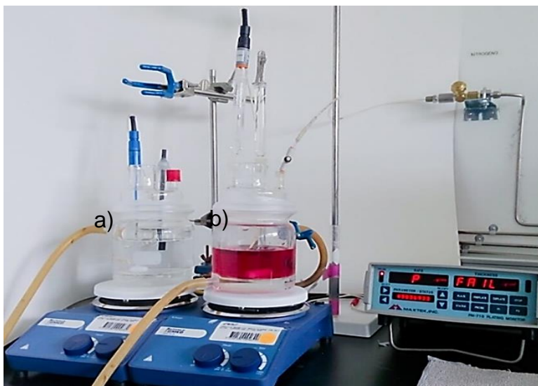
Figura 1.3 Celdas electroquímicas utilizadas en el estudio VC-MECC. a) Solución 1.0 M \text{H}_2\text{SO}_4 para la limpieza y/o activación del electrodo Pt-MECC y b) Solución de estudio.
