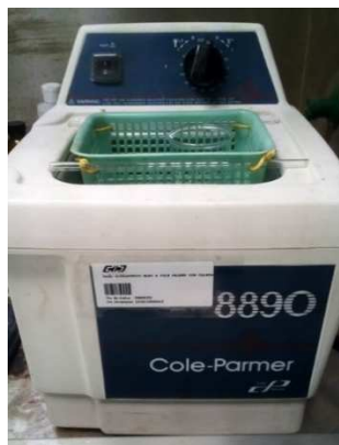
Fig 2.2 Baño ultrasónico (42 kHz) marca Cole-Parmer con calefacción.
