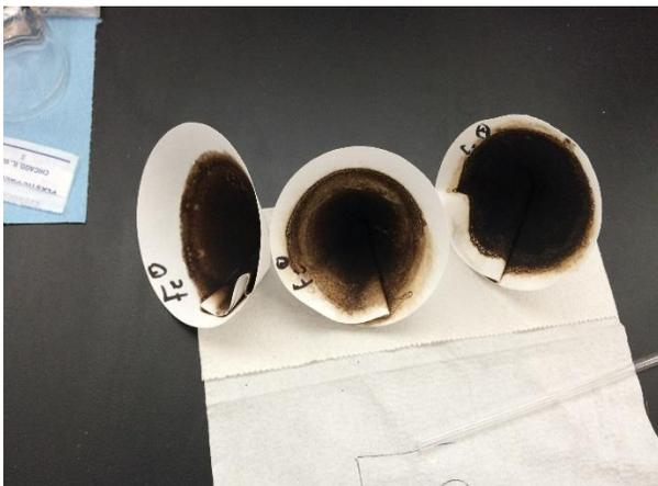
Fig. 8 Lodos residuales de EC con electrodos de Fe.
