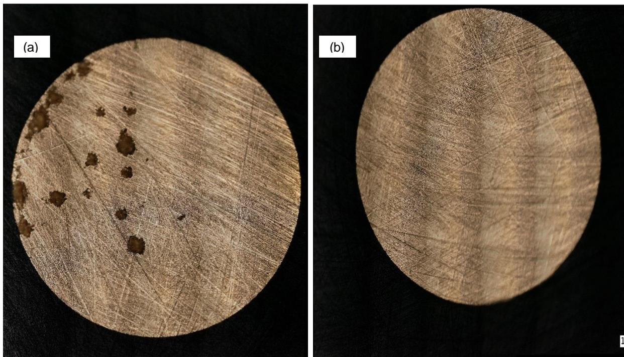
Fig. 13 Electrodo de oro (a) antes y (b) después de ser lijado para eliminar huecos generados por corrosión.
