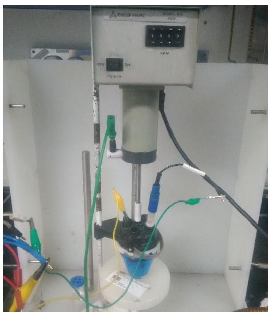
Figura 19 Celda electroquímica acoplada a un equipo de disco rotatorio.
