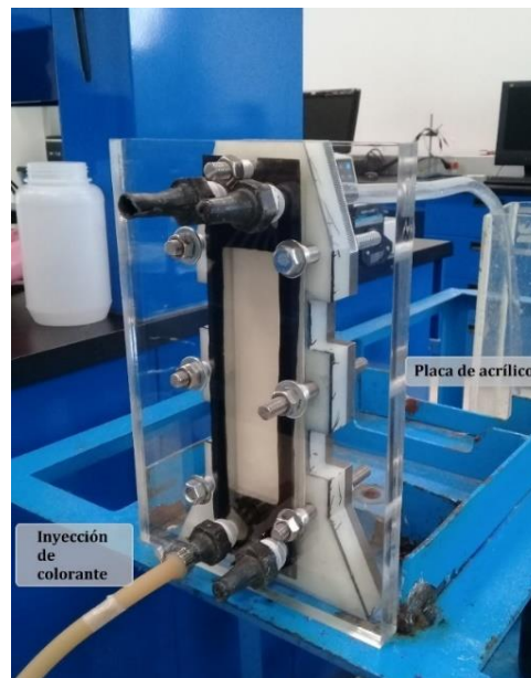
Figura 15 Reactor Asahi, montado para realizar la visualización de flujo.
