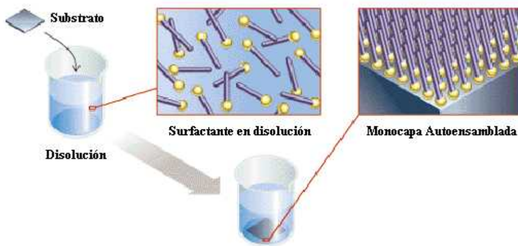
Figura 28-I. Esquema de preparación y estructura final de las Monocapas Autoensambladas (MAEs). 97
