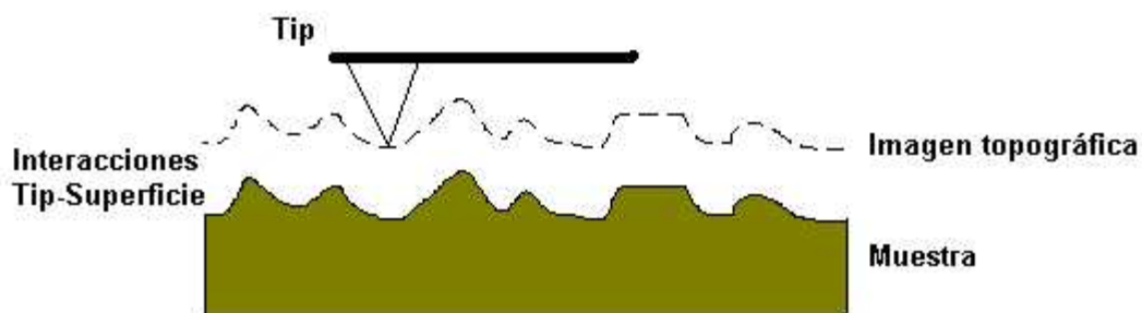
Figura 2-AII-I. Las interacciones tip-superficie de corto alcance pueden generar la imagen topográfica en tres dimensiones de una superficie.
