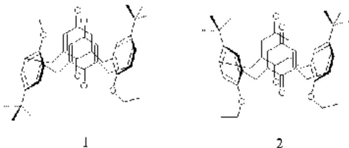
Figura 19-I. Dos calixarenos típicos, (1) syn-calix[4]areno y, (2) anti-calix[4]areno 55 .
