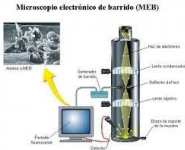
Figura B4 Esquema general de microscopio electrónico de barrido [58]
