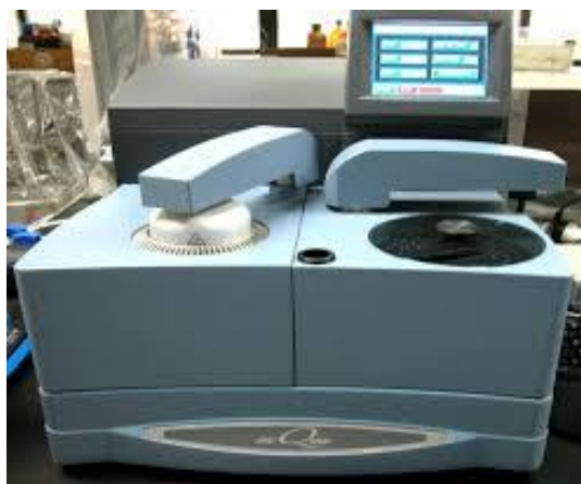
Figura B5 Calorímetro típico de uso en la determinación de calorimetría diferencial de barrido.
