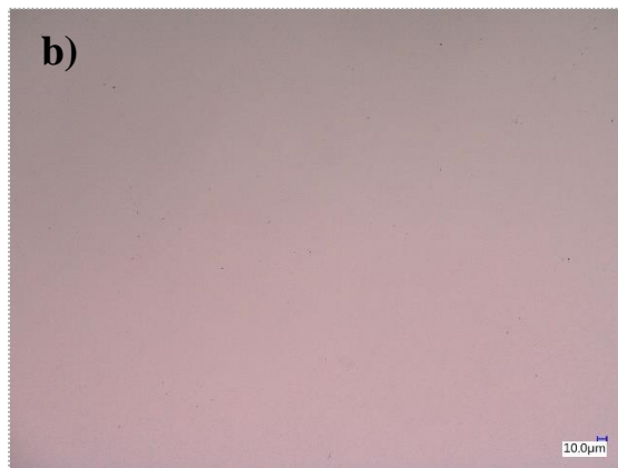
Figura 28. Morfología de la superficie reflectante de plata con y sin recubrimiento de protección: a) muestras antes de ser sometidas a las pruebas de intemperismo acelerado, b) superficie limpia de Ag y c) superficie limpia de Ag con recubrimiento de SiO 2 .
