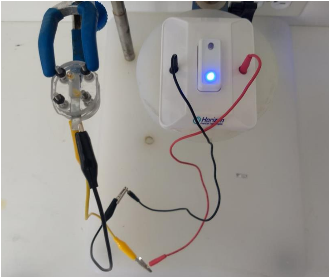
Figura 76 Fotografía de la ZAB durante el suministro de energía requerida para encender LEDs
