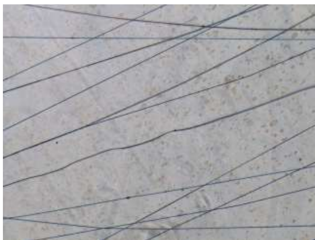
Figura 38. Imagen de las fibras obtenidas por la técnica de electrohilado de PCL con CeO 2 NPs
