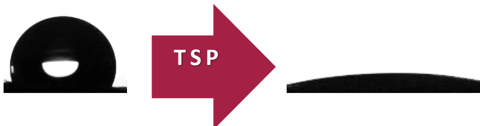
Figura 45. Esquema de los cambios en la hidrofiliidad de las membranas de PCL + CeO 2 NPs
