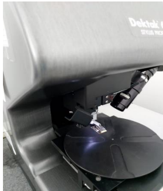
Figura 1.6. Fotografía del perfilómetro Veeco Dektak 6M.
