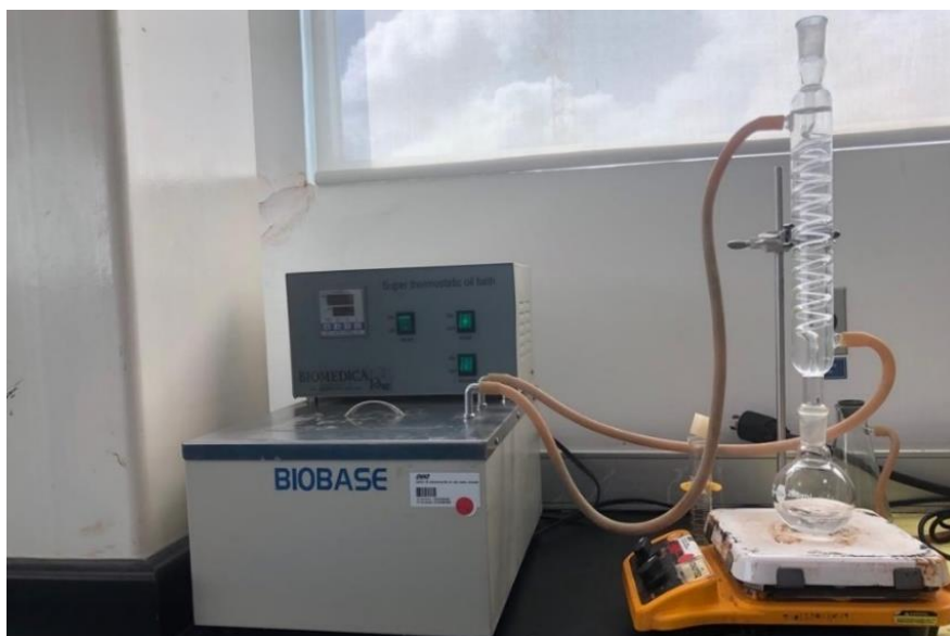
Figura 14. Saponificación de una muestra de aceite para la determinación del índice de saponificación.
