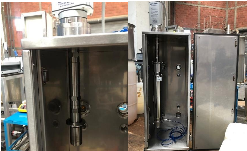
Figura 21. Sonotrodo BS4d40 (izq.) y celda de flujo Hielscher (der.)
