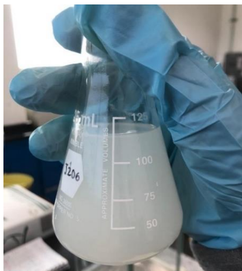
Figura 28. Metóxido de potasio obtenido en la prueba de solubilidad
