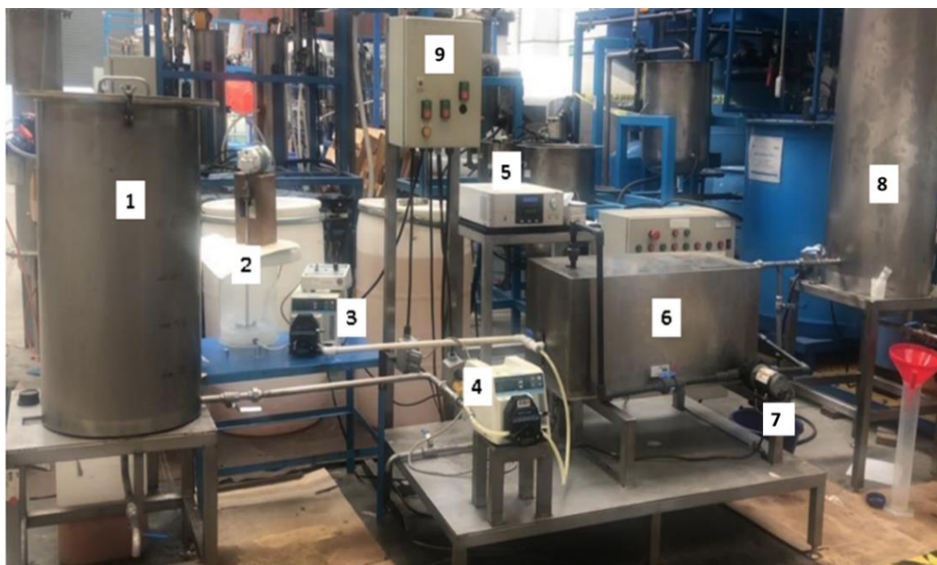
Figura 18. Sistema semipiloto continuo para la producción de biodiésel empleando ultrasonido y recirculación.
