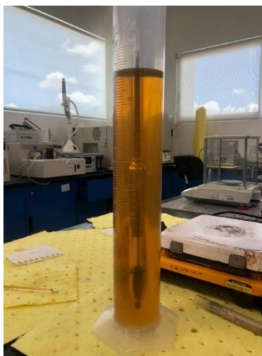
Figura 13. Modo de empleo del hidrómetro para la determinación de la gravedad específica del aceite.
