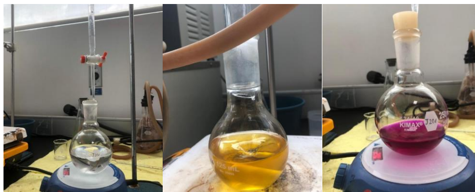
Figura 26. a) Apariencia del blanco, b) Apariencia de una muestra de aceite saponificada, c) Apariencia de una muestra después de añadir la fenolftaleína etanólica.
