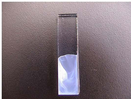
Figura 17. Película de TiO_2 obtenida por EPD durante 40 s de tiempo de depósito sobre un OTE a 298 K.
