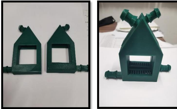
**Fig. 49** Canales de flujo obtenidos mediante impresión en 3D utilizando materiales de nylon y ABS.
