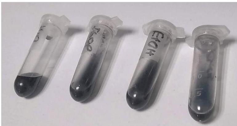
Figura 7. Dispersiones de PANI calcinada en diferentes solventes. (De izquierda a derecha: agua, isopropanol, etanol y tolueno).
