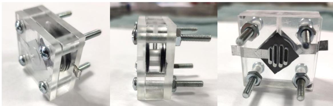
Figura 38. Fotografía de batería ensamblada usada para las pruebas.
