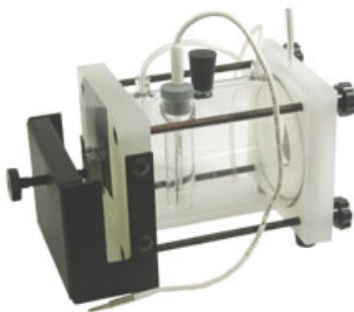
Figura 2.6 Celda de vidrio de tres electrodos marca PAR (K0235) utilizada para realizar las pruebas de corrosión.
