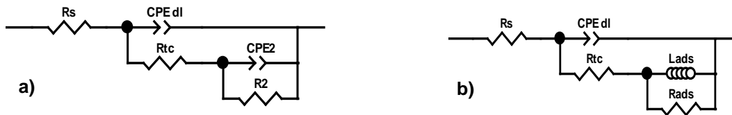
Figura 3.28 Circuitos equivalentes empleados para simulación de los espectros de impedancia obtenidos a partir de una disolución de 0.58 M de \text{NH}_2\text{HSO}_3 , 0.57 M de \text{Ni}(\text{CO}_3)_2 , 0.32 M de \text{H}_3\text{BO}_3 con (24.6 mM de \text{Sm}^{+3} ) y sin adición de samario: a) para un potencial de -0.8 V, b) para los potenciales -0.85 V, -0.9 V y -1.0 V.
