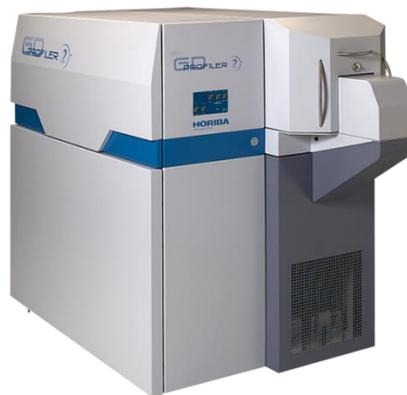
Figura 12. Equipo de análisis de perfil elemental GD.Profilometer 2 Horiba.
