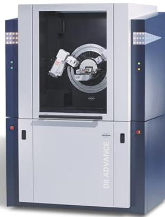
Figura 8. Difractómetro de rayos X Bruker DV8 Advance.
