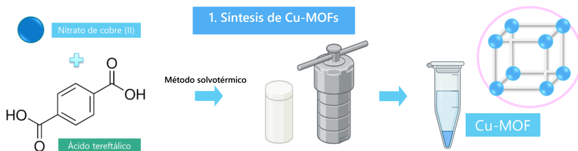
Figura 2.8 Metodología de síntesis de Cu-MOF por el método solvotérmico.
