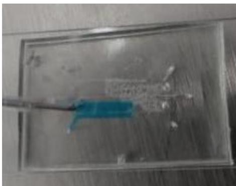
Figura 117. Depósito de hidrogel de colágeno al 30 % en el chip microfluídico con dos cámaras de cultivo.
