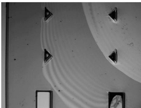
Figura 108. Microscopía óptica (4x) de los patrones en la oblea de silicio. Chip de dos canales de cultivo 20 mW 60 % después de aplicar PDMS.
