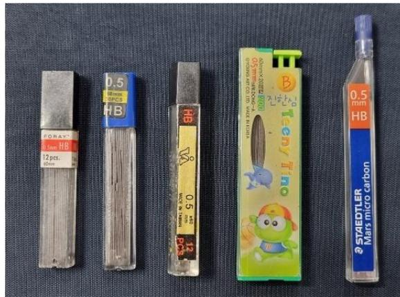
Figura 85. Marcas de puntillas de carbono utilizadas como electrodos de trabajo.
