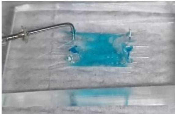
Figura 110. Depósito de hidrogel de alginato de sodio en chip microfluídico.
