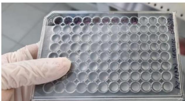
Figura 20. Microplaca de ultra baja adherencia para la formación de esferoides.
