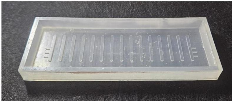
Figura 98. Molde para fabricación de canales microfluídicos.
