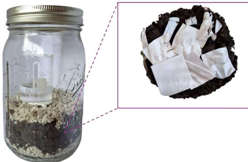
Figura 25 Esquema del montaje experimental para la evaluación de la biodegradación del nanocompuesto PVA/PAA-Cu-Fe<sub>2</sub>O<sub>3</sub>
