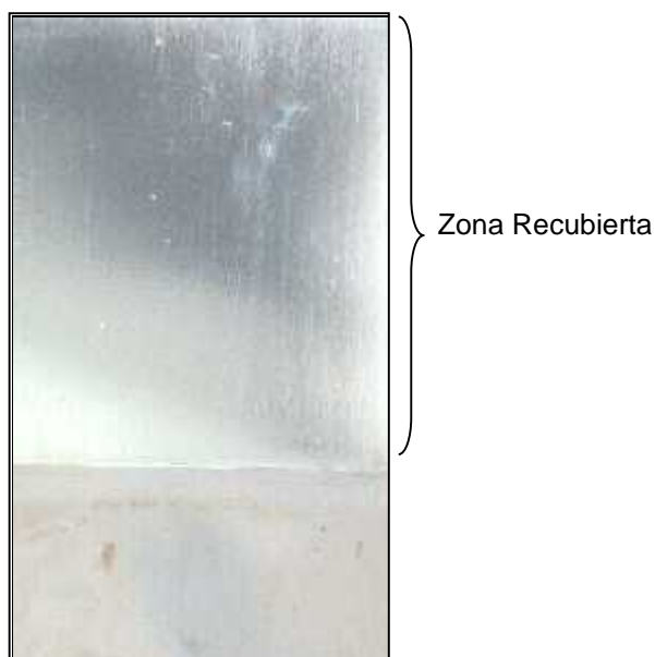
Fig. 15 Recubrimiento de cinc obtenido en celda de placas paralelas a partir del baño electrolítico propuesto (10 µm espesor calculado).
