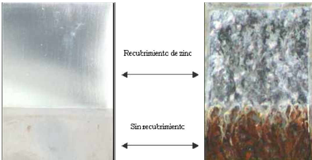
Fig. 17 Recubrimiento de cinc antes y después de la prueba en cámara de niebla salina
