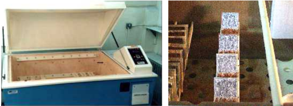
Fig. 16 Cámara de Niebla Salina (exterior e interior).
