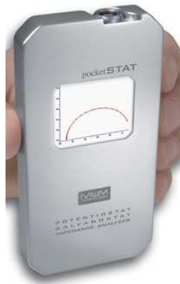
Figura 37. Potenciostato portable marca Ivium, modelo pocketstat, tamaño: 115.2 x 58.5 x 12.5mm, peso: 140 g, tamaño: 115.2 x 58.5 x 12.5mm, ventana de potencial: ±4V / ±10mA, impedancia de entrada ≥ 1TΩ, resolución ± 10mV.
