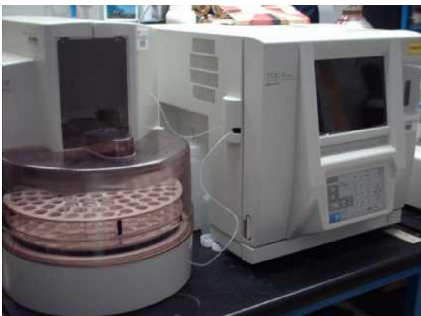
**Fig. A.6.1** Analizador de Carbón Orgánico Total Shimadzu COT-V<sub>CSN</sub>.
