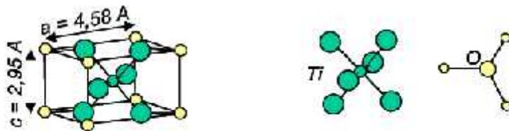
Fig. 2.3 Estructura Cristalográfica de la fase Anatasa del  $\text{TiO}_2$ .
