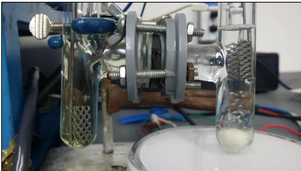
Fig. 13. Celda electroquímica de doble compartimento separada por una membrana de intercambio iónico, en el ánodo va un electrodo de Pt junto con el electrodo de referencia que es sulfato mercurioso (izquierda) y en el cátodo un electrodo de Pt (derecha).
