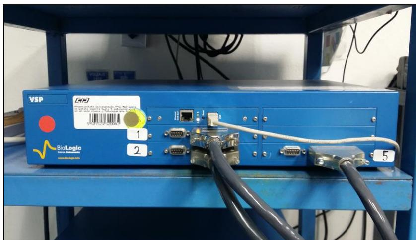
*Fig. 9. Potenciostato – Galvanostato VPS marca Bio – Logic.*
