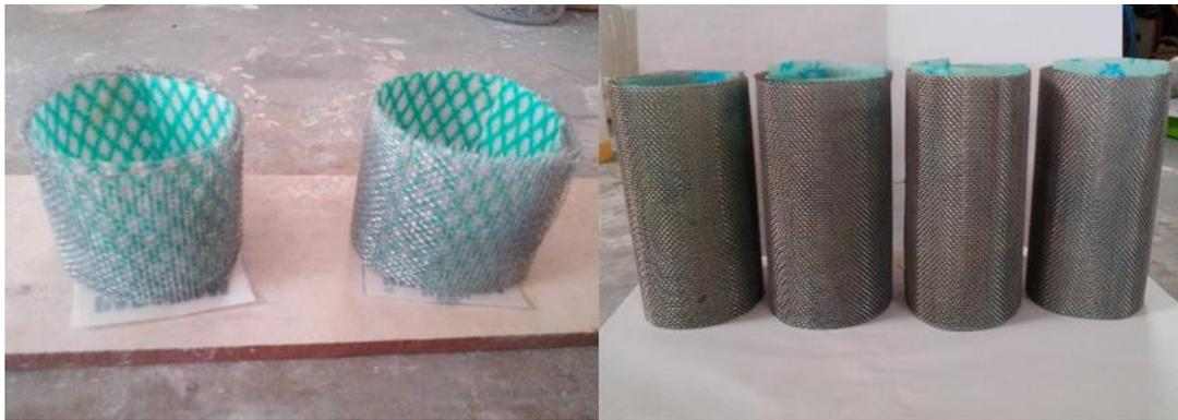
**Figura 0.3** Estructura de los moldes elaborados con malla de acero inoxidable y tela “tejido abierto”.
