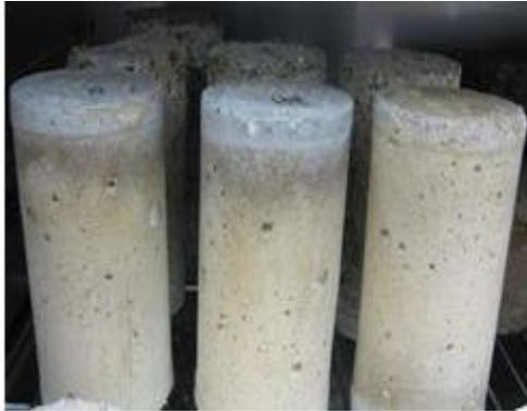
*Figura 0.2 Geopolímeros elaborados con ceniza volante y sol-gel con tratamiento térmico.*
