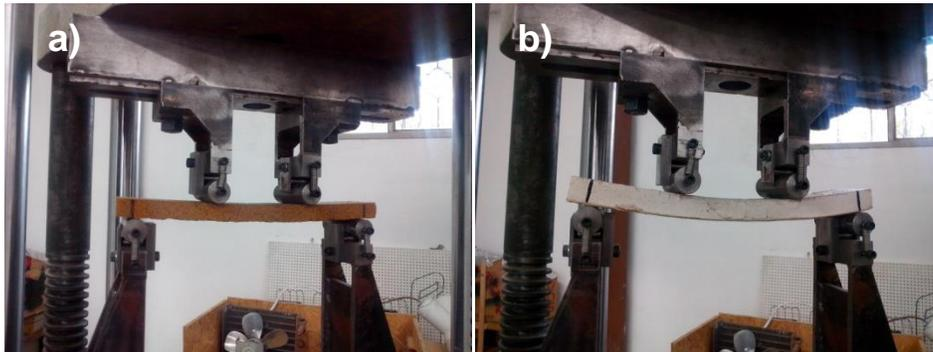
**Figura 0.9** Muestras sometidas a ensayo de flexión, a) proporción 20% MK-80%CA, b) proporción 60% MK-40%CA.
