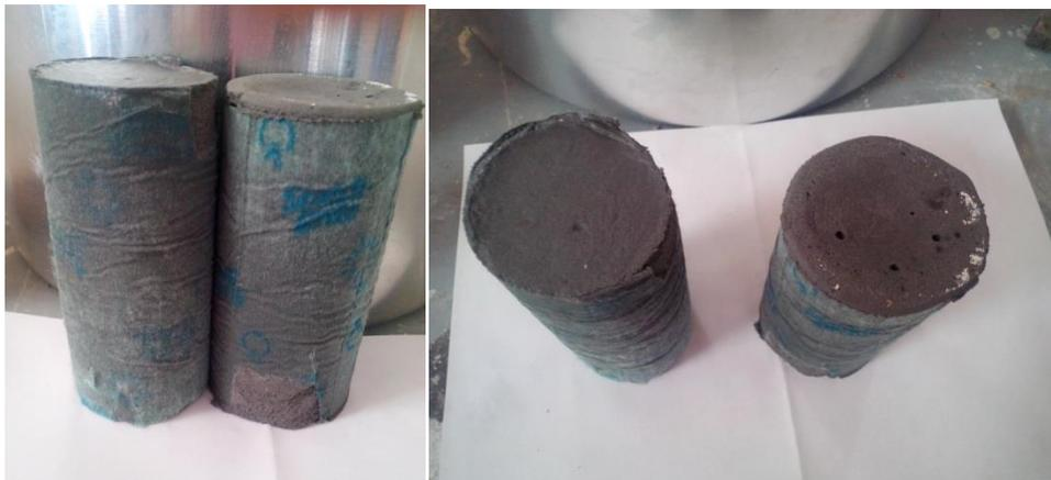
**Figura 0.1.** Geopolímeros elaborados con ceniza volante y sol-gel sin tratamiento térmico.
