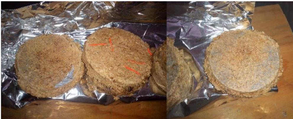
*Figura 0.5 Pastillas elaboradas a base de urea formaldehído y cascarilla de arroz.*
